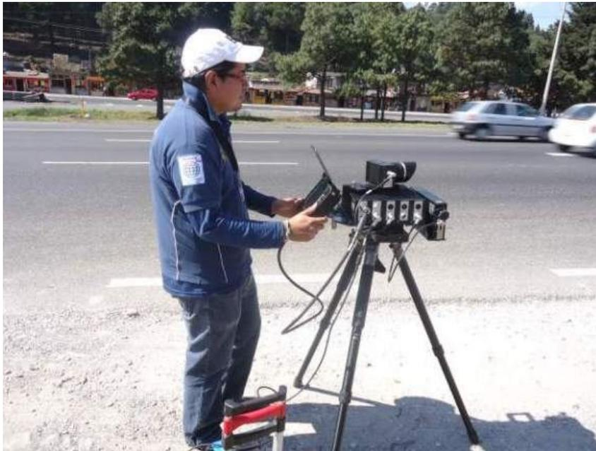
**Fotografía 39.-** Radar en operación, de la compañía Autotrafic S.A de C.V. Información que proporciona el radar: velocidad, hora, fecha y fotografía del vehículo.
